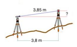
Quel dénivelé y a-t-il entre les deux instruments de mesure cicontre?
