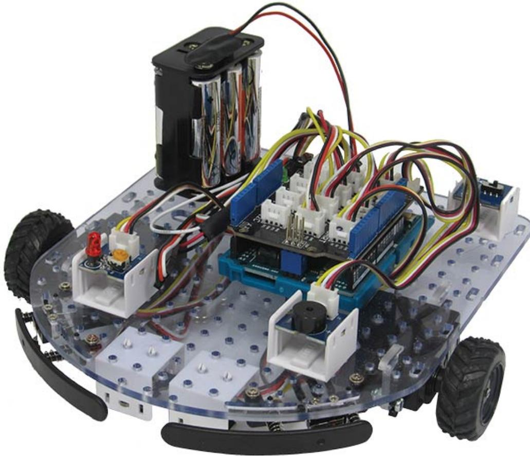
Le robot est évolutif, on peut lui ajouter plusieurs options (suiveur de ligne, capteurs ultrasons, affichage LCD, étage supplémentaire...)
